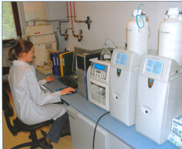
Zuzanna Cieśla na chromatografii jonowym DIONEX oznacza jony w wodach opadowych i glebowych.
