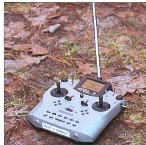
Stewowanie odbywa się za pomocą specjalnej konsoli, do której możliwa jest integracja wideookularów.
