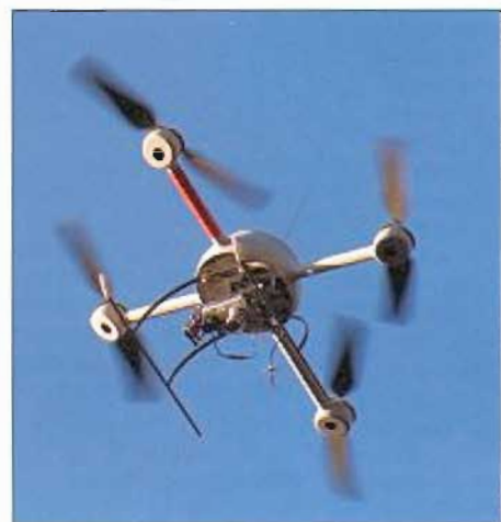
Do Microdrone można podłączyć kamerę wideo, kamerę cyfrową rejestrującą obraz w podczerwieni, lub aparat cyfrowy.
