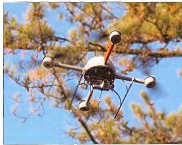
Zasięg urządzenia określa się na 500 metrów i ograniczony jest możliwością jego obserwacji i sterowania.
