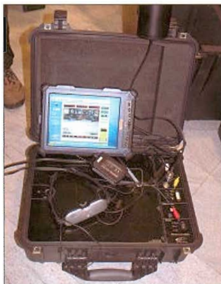
Stacja bazowa zawiera m.in. panel sterujący, wideookulary oraz antenę odbiorczą.
